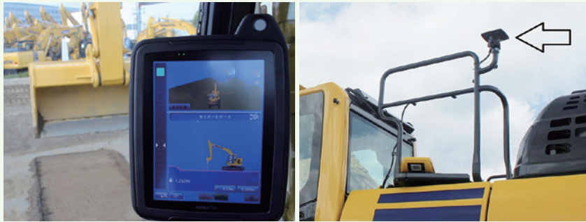
試乗したICT建機。転送された3次元設計データにより自動制御され、コントロールボックス（ICT専用モニター）を確認しながらスムーズに作業が可能
