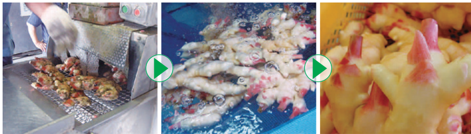
4 マイクロバブルによる生姜の洗浄(写真提供・お問い合わせ先: 高知工業高等専門学校秦隆志准教授)
